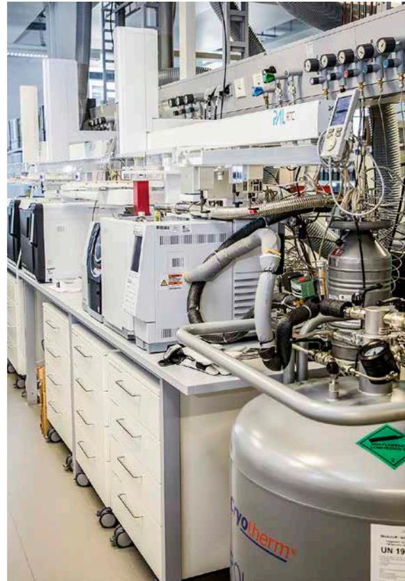
**Abb. 1.10: Analysegeräte zur automatisierten Prüfung der Speiseölauthentizität (GC-FID und SPME-GCxGC-MS)**
