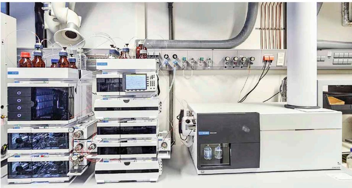
Abb. 1.43: Ansicht des einsatzbereiten 2D-LC-QTOF
