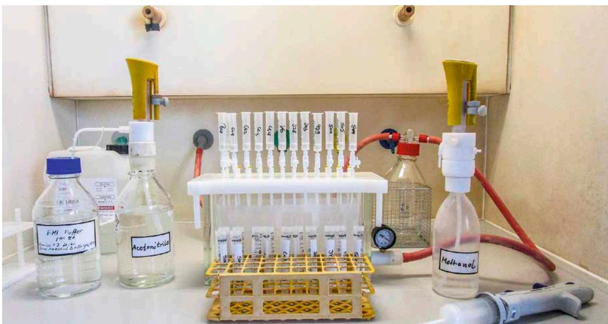
Abb. 1.26: Aufbau der Festphasenextraktion zur Aufreinigung von Probenextrakten
