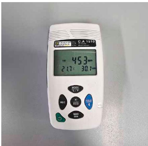
**Abb. 4.5: CO<sub>2</sub>-Messgerät mit Temperatur- und Feuchtigkeitsangabe**
